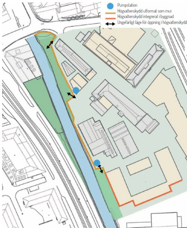
Illustration av princip för högvattenskydd (Mareld), Exempel på högvattenskydd med igensättningsbar öppning, byggt i Kungälv.
